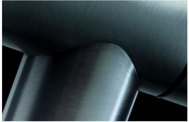
LASERDYNE 811 的所有高级功能都能有效融入 VOLA 的生产流程中。这一过程涵盖了多次样本测试、金相分析、定制夹具设计，以及精准选择激光波长、光学配置和功率级别，以满足 VOLA 的独特需求。
