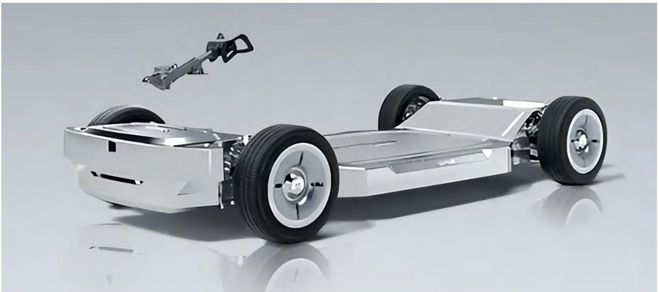
造型、整车智驾、整车座舱、整车交互等所有的数智化工作，也就是用户直接能体验到的这些东西由主机厂、移动出行商去完成，这是最合理的，这条路径最短、效率最高。但是我们看到电动车底盘的时候，觉得好像不是很完美。为什么不完美？市面上有 80%~90% 的电动车是由传统的 ICE 底盘改造的，它并不是真正的电动车底盘。现在国际大厂开始构造下一代的纯电动车底盘，其实也不是特别理想。但是大家都在做这件事情。在中国，每个车企要新推出一代车型的时候，推一个平台，就要重新考虑如何构造一个基于传统 ICE 底盘的电动车。我们说这是一个纯电动的车，但架构是延续了 100 多年的传统架构。
