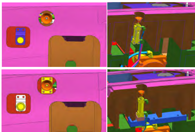
图五、顶料机构改善前后模具结构对比
