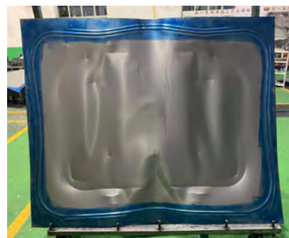
图3 OP10 压边圈与凸模着色图
