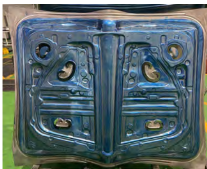
图3 OP10 压边圈与凸模着色图
